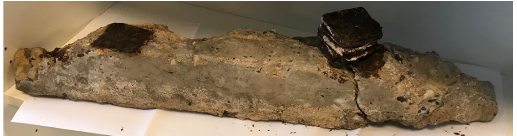
Kant af bærende beton-altanplade "skudt" af + vederlagsplader af stål fra søjleportal.
