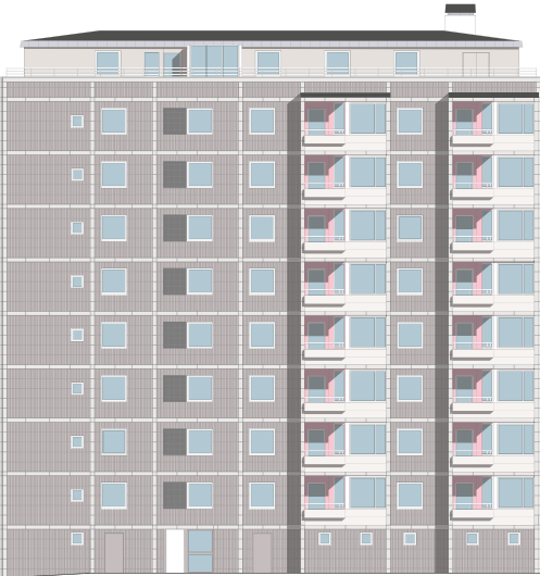
Facadeeksempel, udvidet facadeplan N.B. Det viste facadeeksempel er reelt i 13 etager, men er vist forkortet i 9 etager M 1:100
